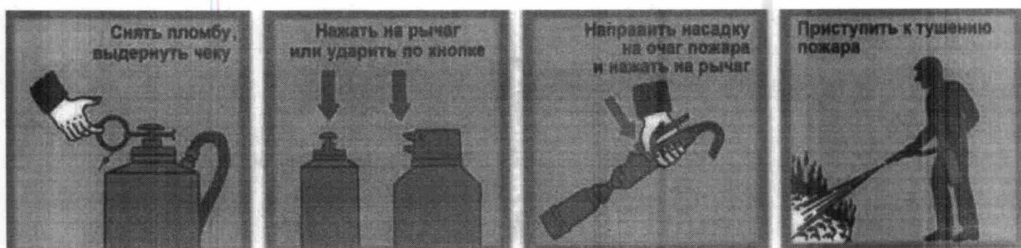
Приведение в действие ручного углекислотного огнетушителя (плакат)
